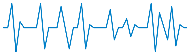
Typowy wzór stanu naładowania podczas jazdy pojazdem z systemem Start-Stop.
